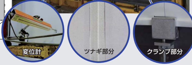
風圧による 試験体の変形歪みを 計測する機器
